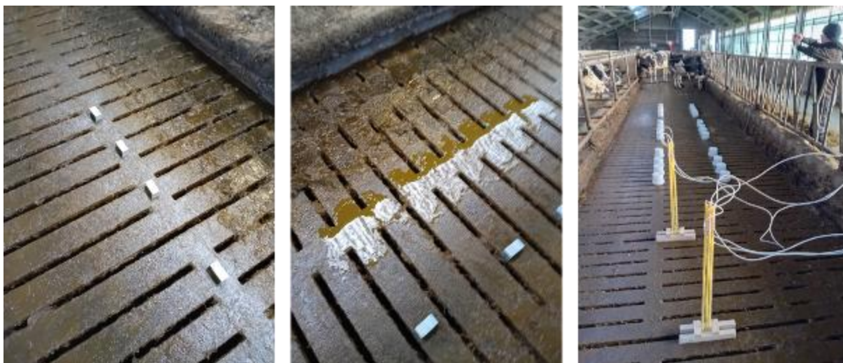
Figuur 3-4 Links: de onbehandelde referentie voordat de petrischaaltjes en emmers werden geplaatst. Midden: vloer gespoeld met dunne fractie. Rechts: op de achtergrond de meetopstelling nadat de petrischalen en emmers zijn geplaatst. Op de voorgrond de meetopstelling voor het meten van de gasconcentraties in de mestkelder.
